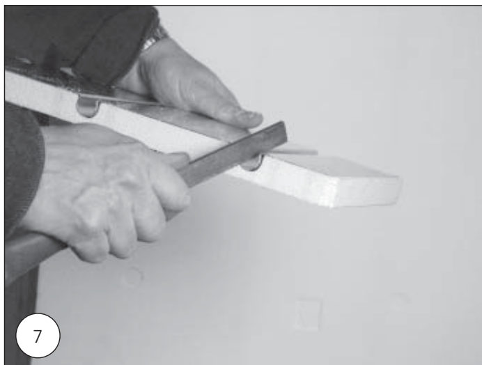
7 Grater fra rørsprene SKAL fjernes med en fil.
